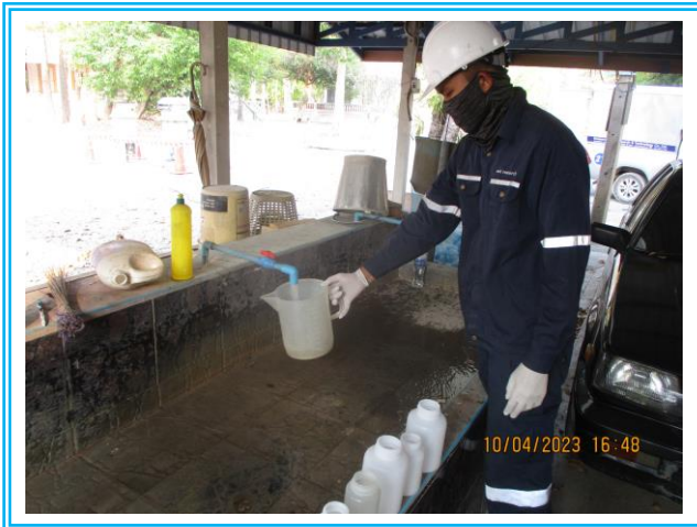
รูปที่ 4.3-30 แสดงเก็บตัวอย่างเพื่อตรวจวัดคุณภาพน้ำใต้ดิน บริเวณน้ำบาดาลบ้านใหม่เขาปูน วันที่ 10 เมษายน 2566
