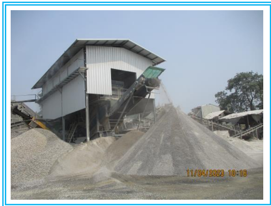
รูปที่ 3-7 อาคารโรงโม่แบบปิดคลุม
