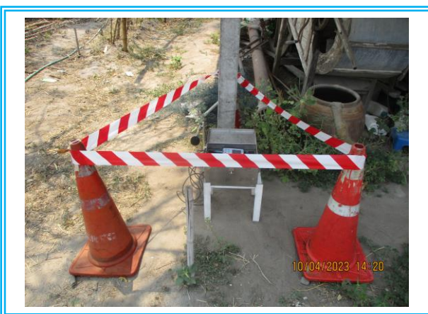
รูปที่ 4.3-20 แสดงการตรวจวัดความสั่นสะเทือน บริเวณบ้านกระซอนล่าง วันที่ 10 เมษายน 2566
