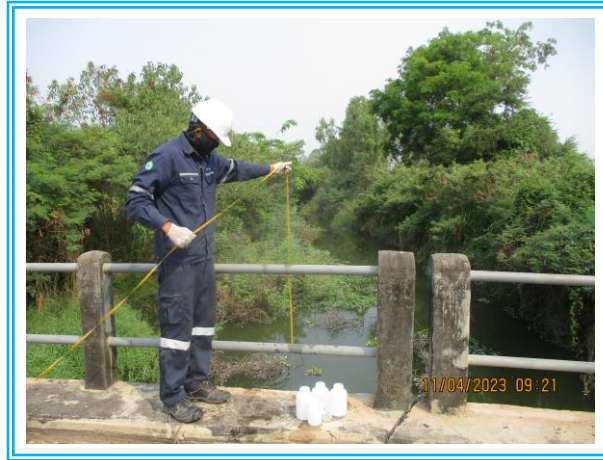
รูปที่ 4.3-21 แสดงการเก็บตัวอย่างเพื่อตรวจวัดคุณภาพน้ำผิวดิน คลองวังน้ำขาว บริเวณช่วงก่อนไหลผ่านใกล้เคียงโครงการ วันที่ 11 เมษายน 2566
