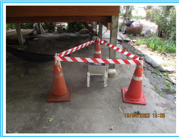
รูปที่ 4.3-18 แสดงการตรวจวัดความสั่นสะเทือน บริเวณบ้านร่องไม้แดง วันที่ 10 เมษายน 2566
